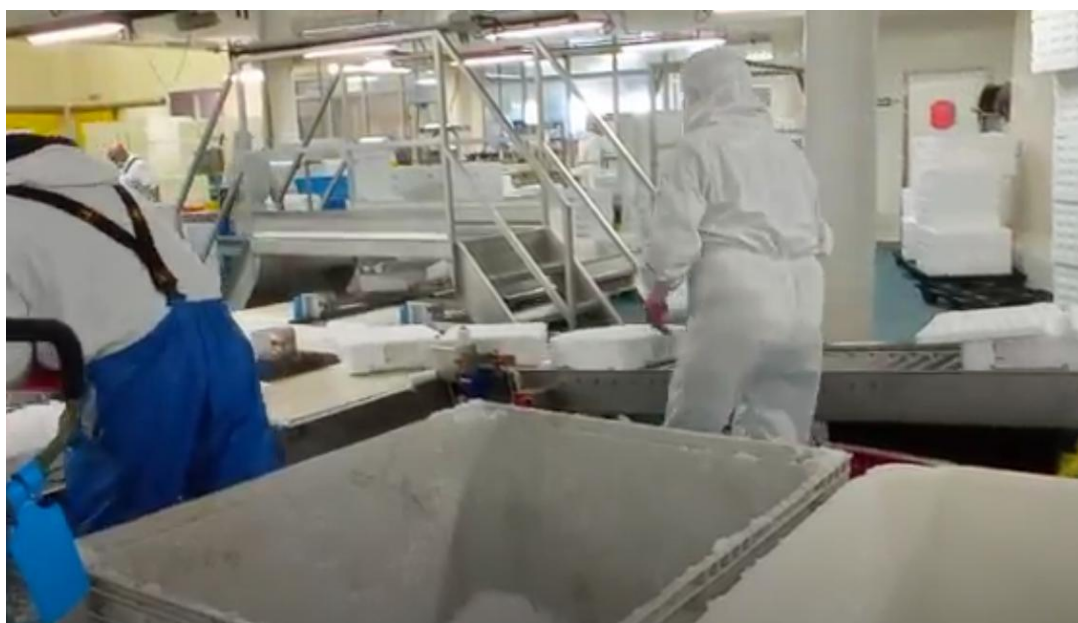
Figure 10 : Les caisses en polystyrène peuvent provoquer des « grincements » contre les bandes du convoyeur
